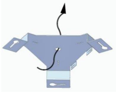
5. Verificare che il cordino anticaduta fornito in dotazione sia correttamente installato. Non installare il gruppo ottico al corpo lampada senza il cordino anticaduta!!!
